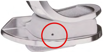
Отверстие не запаяно
