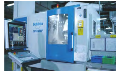
Пятиосевой шлифовальный станок с ЧПУ Schütte (Германия)
