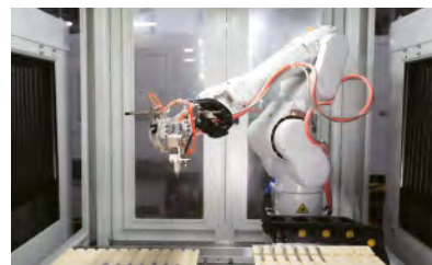
Автоматизированный роботизированный манипулятор для загрузки и разгрузки
