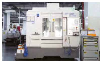
Двухшпиндельный, двухпозиционный, двухповоротный станок с ЧПУ
